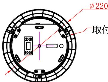
取付時天井開口直径200mm
